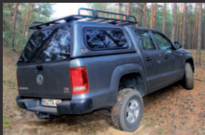
▲ Nicht nur die Bodenfreiheit, auch die Verschränkung wächst mit dem OME-Umbau-Fahrwerk.
