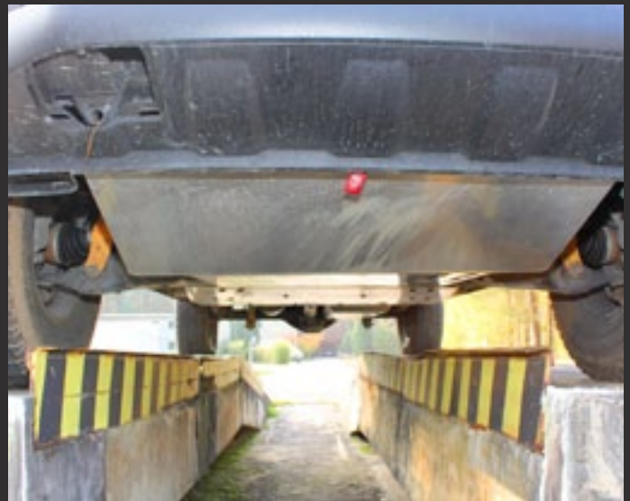
▲ Der Aluminium-Unterfahrerschutz ist dreigeteilt: Motor, Getriebe und Tank lassen sich separat oder komplett abdecken.
