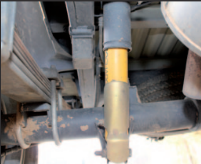
▲ Das ARB-Komplettfahrwerk mit Blattfedern, Federbeinen und Dämpfern umfasst auch einen Steinschlagschutz für die hinteren Stoßdämpfer.
