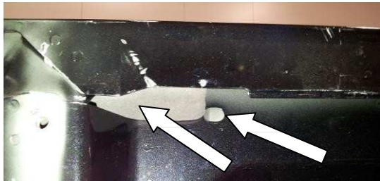
Loch in der vorderen Ecke unter der seitlichen Wannenschiene
