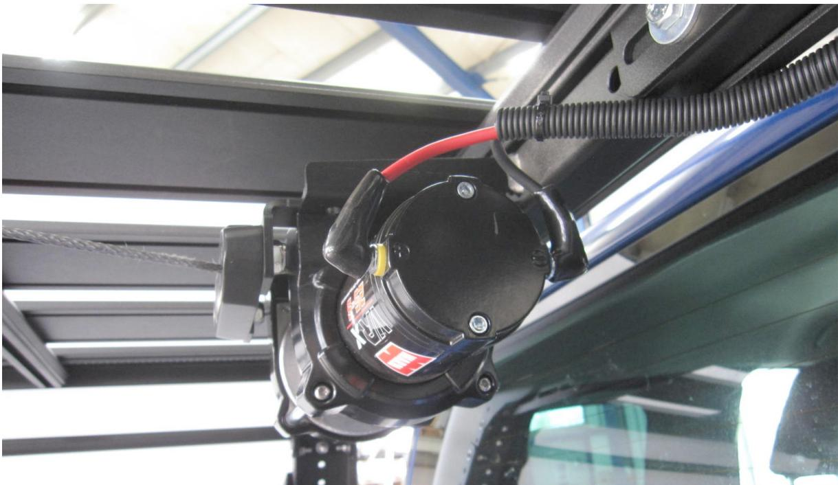
**Seilwinden Anschlusskabel gelb gegen Kabel rot und Anschlusskabel blau gegen Kabel schwarz austauschen und ggf. kürzen!**
