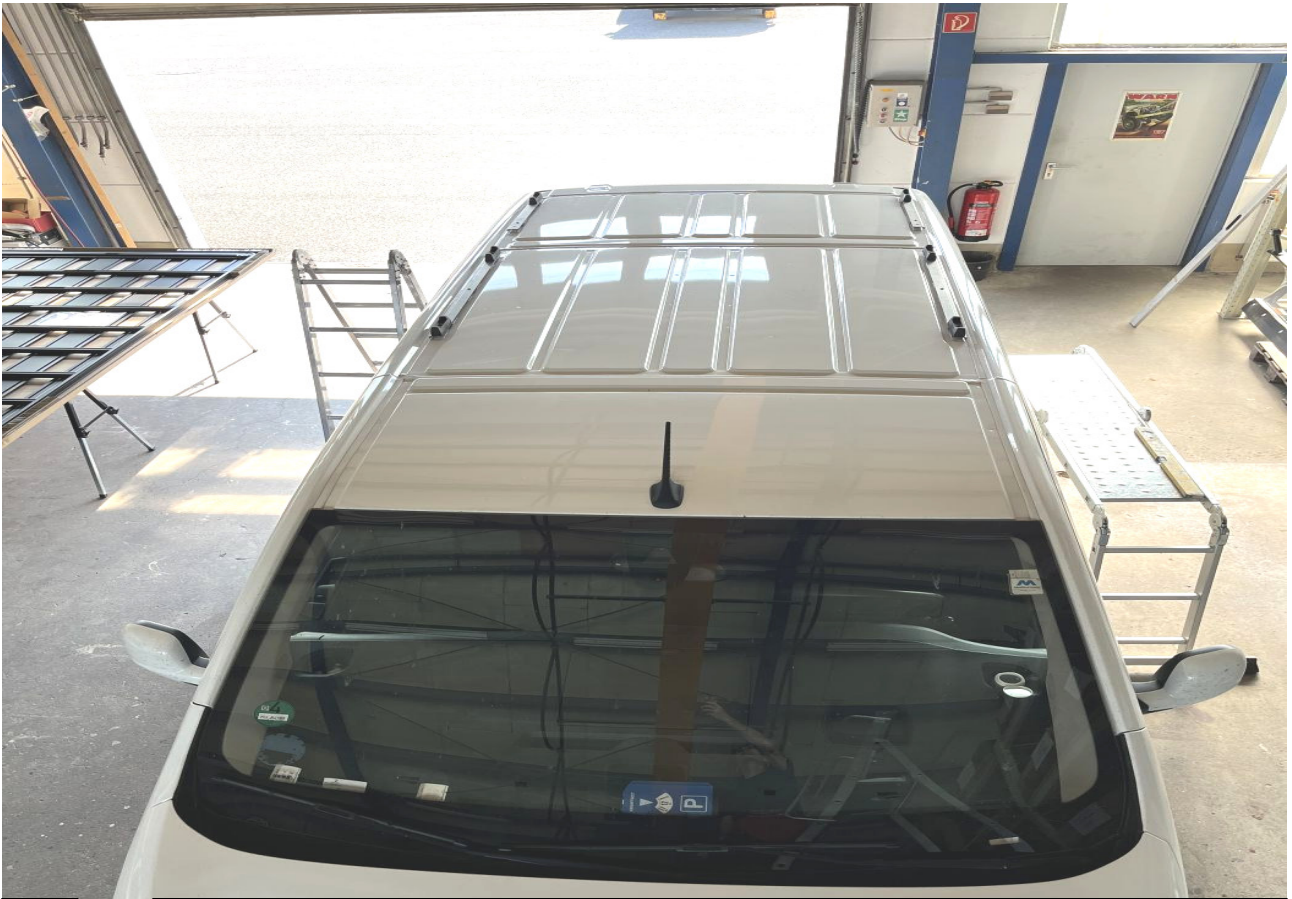
Basisplatten komplett montiert / Base plates complete mounted
