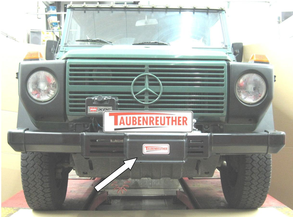
**Hier sehen sie den fertig montierten Seilwindenanbausatz.**
