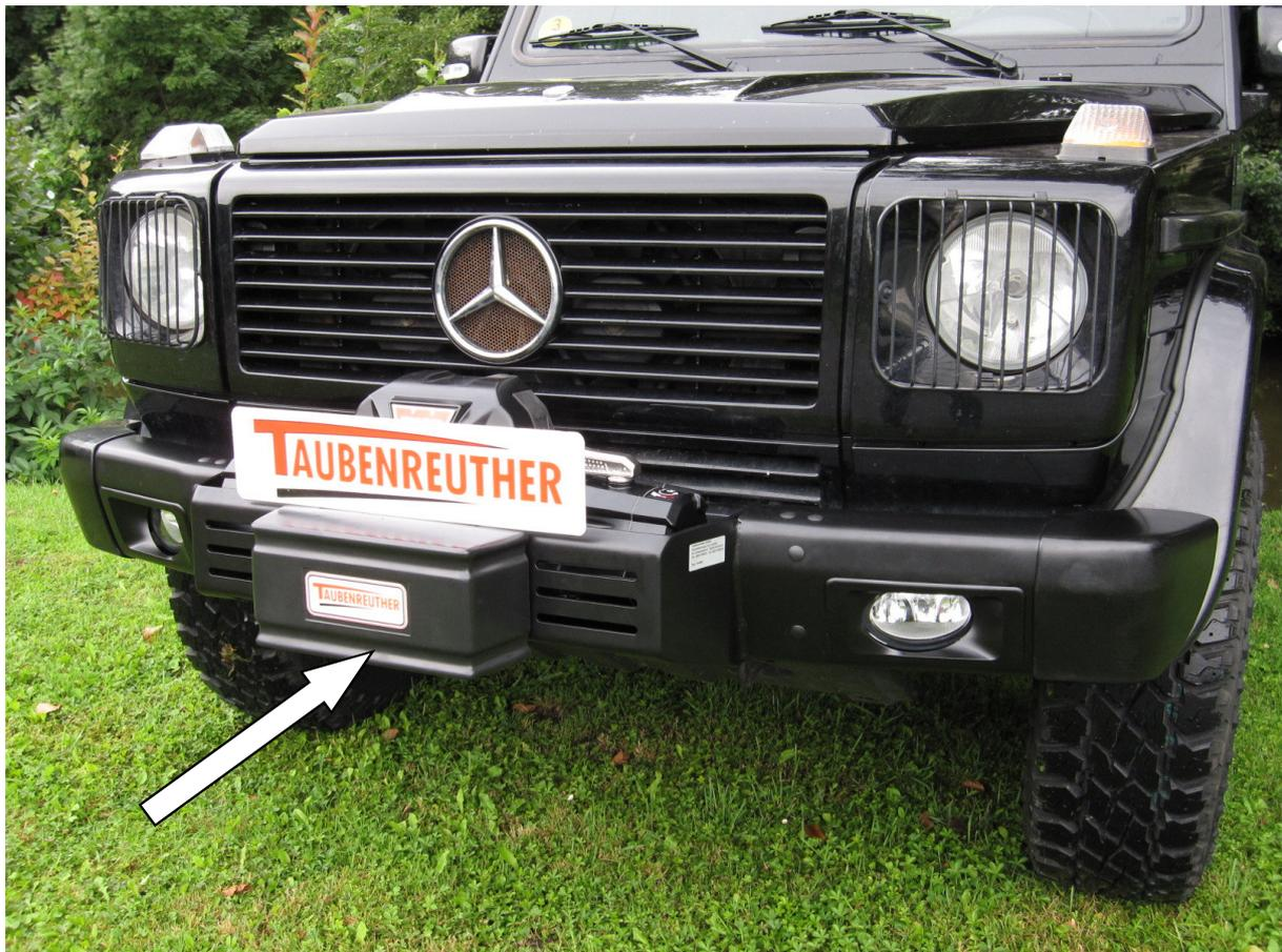
**Hier sehen sie den fertig montierten Seilwindenanbausatz.
